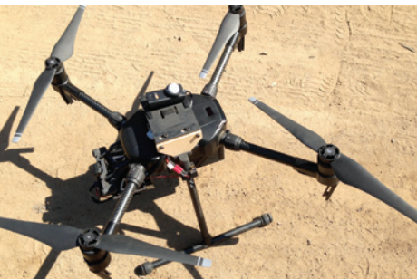
1A. Sensor pasivo montado en dron.
