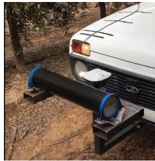
Sensor de rayos gamma SoilOptix (gentileza de SoilOptix, Canadá y Neoag Agricultura de Precisión).
